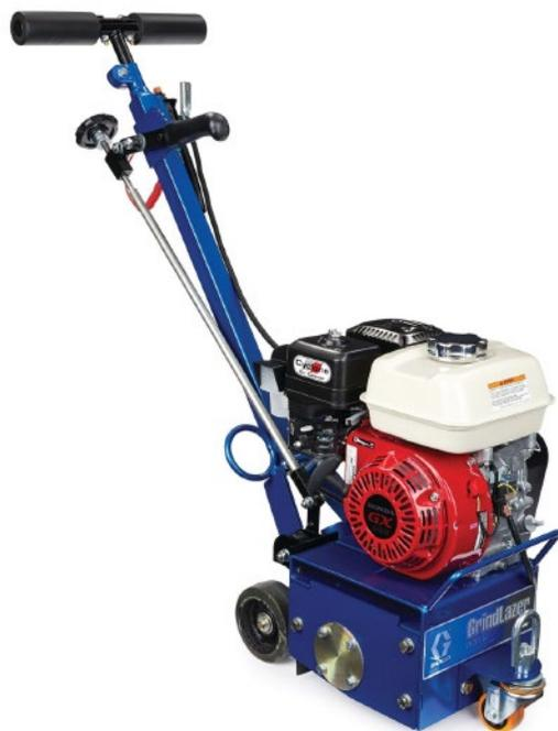
El GrindLazer Standard DC87 G es un escarificador ideal para trabajos de menor escala en la eliminación de marcas viales, peligros de tropiezo y preparación de superficies para la aplicación de nuevas señalizaciones.
